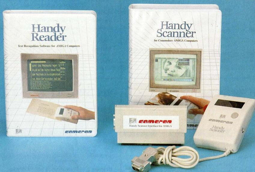
**Hardwaremodul am Expansionport, mausgroßer Scanner und die richtige Software ergeben eine neue Benutzerschnittstelle.**
